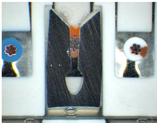
Microsection du bloc de câblage IDC de R&M
